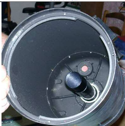
voilà , le seau est vide ( mais percé ) IMPORTANT A NOTER : l'intérieur du Tube est vraiment ANTI-REFLETS , ce qui est loin d'être le cas de l'INTÉRIEUR DU BAFFLE FIXE ..... où passe tout de même le faisceau Lumineux du Secondaire !!! dont acte ??
