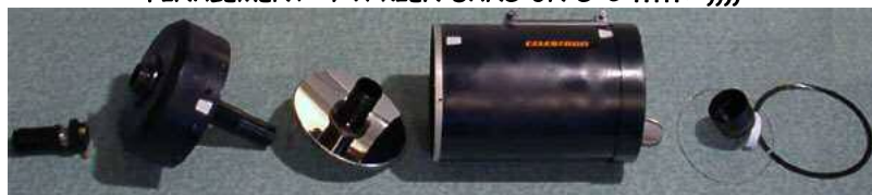
voilà , le seau est vide ( mais percé ) IMPORTANT A NOTER : l'intérieur du Tube est vraiment ANTI-REFLETS , ce qui est loin d'être le cas de l'INTÉRIEUR DU BAFFLE FIXE ..... où passe tout de même le faisceau Lumineux du Secondaire !!! dont acte ??
