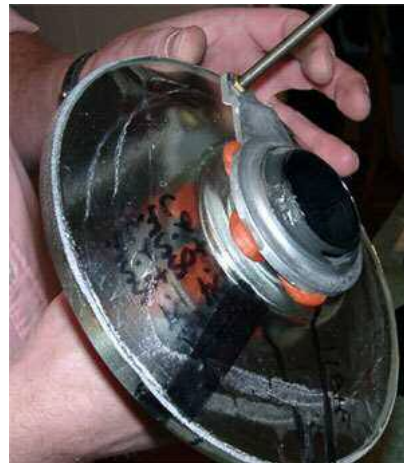
Coté PILE. VU LE DEPORT DE LA VIS DE FOCALISATION JE DOUTE FORTEMENT QUE LE MIROIR PUISSE SE DÉPLACER SANS A COUPS (?) LATÉRAUX
