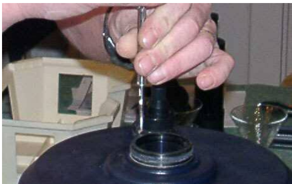
On commence par le démontage de la flasque ( 3 vis ) du palier arrière
