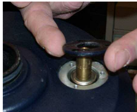
Le bouton de Focalisation ( moleté ) enlevé , on sort le Flasque
