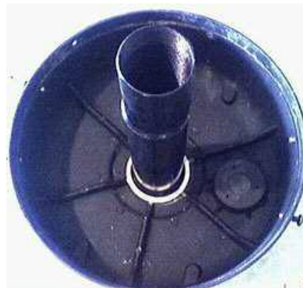
Pour accéder aux modifications futures on désolidarise le Fut du C8 DE SON BARILLET ARRIÈRE , il y a 4 vis écrous de 3 mm !!! en espérant que cela suffise ....
